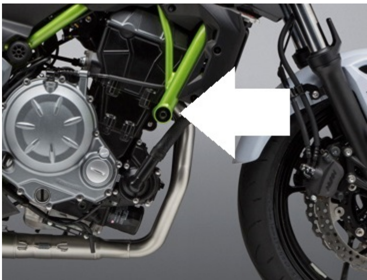
Miejsce montażu (obie strony)
